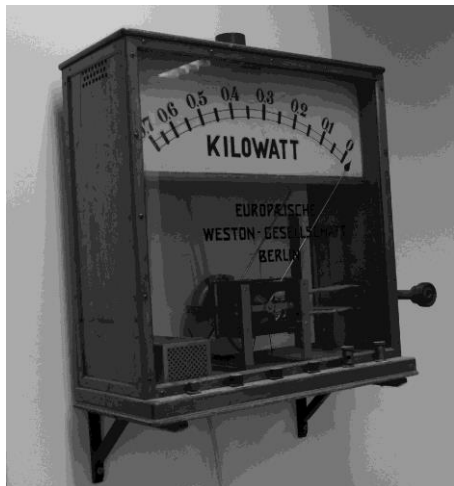
Fot. 11. Zabytkowy model demonstrujący działanie watomierza na ekspozycji w Laboratorium Miernictwa Elektrycznego PG (fot. autora)
