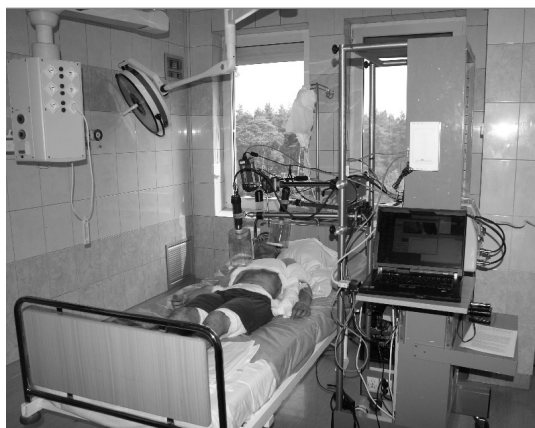
Rys. 3. Stanowisko pomiarowe ADT w warunkach klinicznych badań oparzeń Fig. 3. ADT set in clinical measurements of burns
