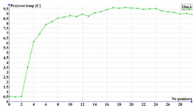
Rys. 5. Przyrosty temperatury warystorów dla prądu 10,0 mA
