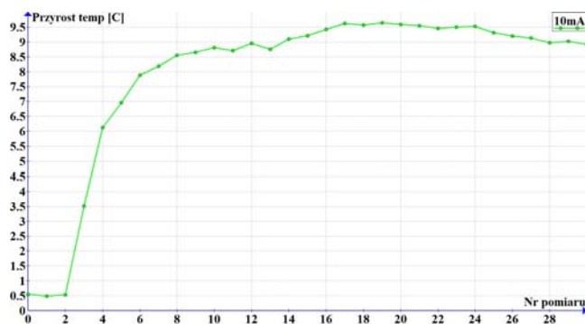
Rys. 5. Przyrosty temperatury warystorów dla prądu 10,0 mA
