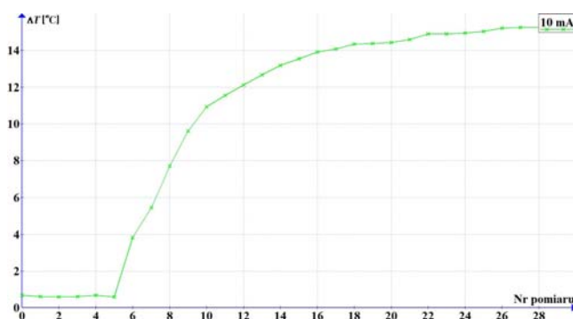
Rys. 3. Przyrosty temperatury diody SM6T39 dla prądu 10,0 mA
