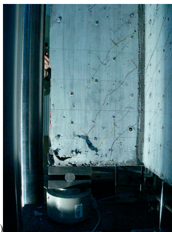
Rys. 7. Zniszczenie tarczy żelbetowej: a) widok ogólny, b) i c) obszar niszczenia bezpośrednio po badaniu
