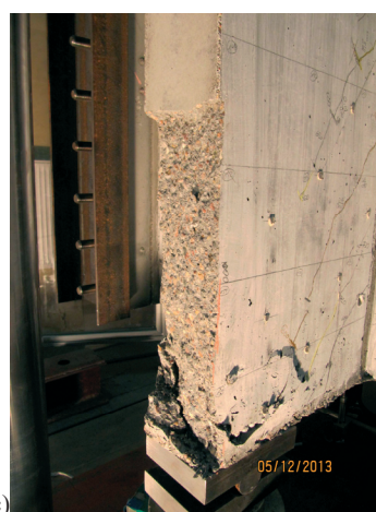
Rys. 7. Zniszczenie tarczy żelbetowej: a) widok ogólny, b) i c) obszar niszczenia bezpośrednio po badaniu
