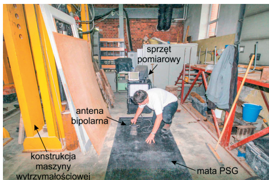
Rys. 1. Badanie konstrukcji podłogi w Regionalnym Laboratorium Budownictwa (Wydział Inżynierii Lądowej i Środowiska, Politechnika Gdańska) za pomocą metody georadarowej z użyciem maty PSG
