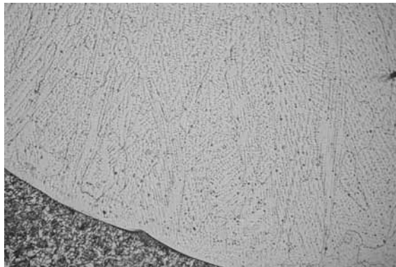
Rys. 16. Dendrytyczna struktura spoiny wykonanej w monelem 400. Pow. 200×
