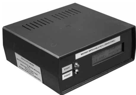
Rys. 7. Model mikroprocesorowego miernika impedancji pętli zwarciowej
