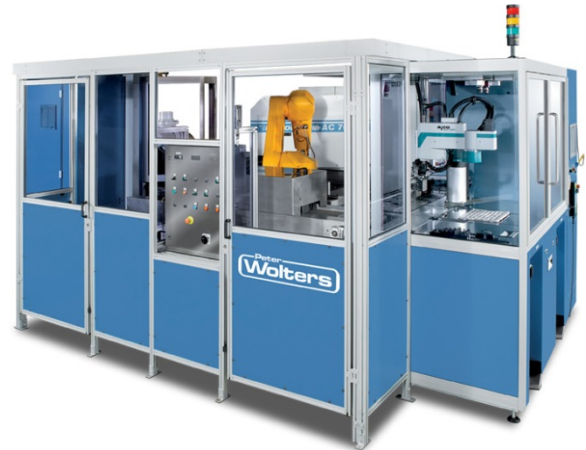
Rys. 13. Wykorzystanie robota, jako podajnika w docierarce firmy Peter Wolters [7]
