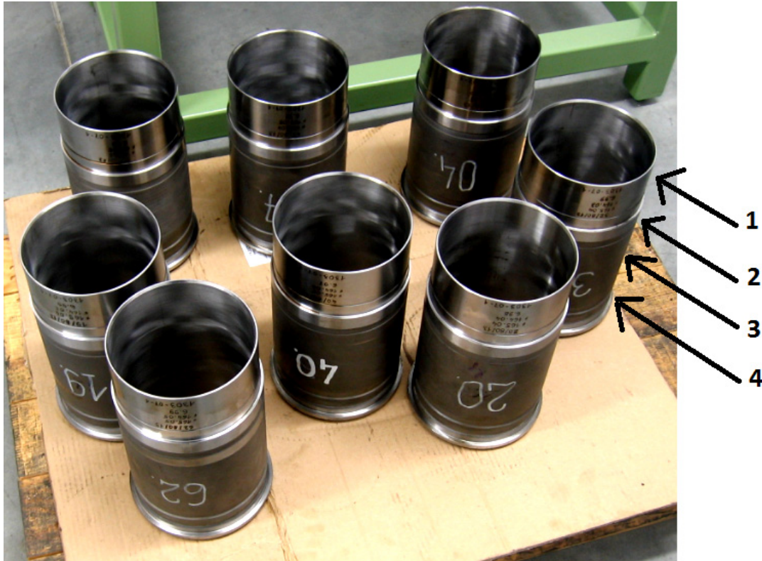
Rys. 7. Analizowane miejsca gładzonej tulei o zmiennej grubości ścianki (grubość g_1 < g_3 < g_2 < g_4 )
