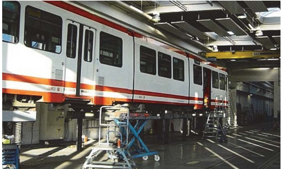
Fot. 7. System podnośników w zmodernizowanej zajezdni we Wrzeszczu Źródło: [11].
