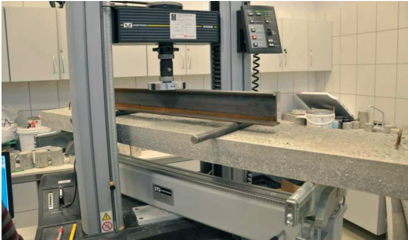
Rys. 5. Próbką żelbetową w trakcie próby niszczącej
