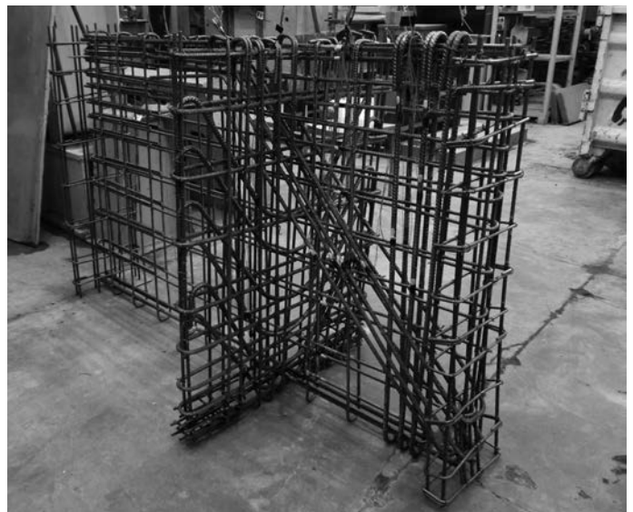
Rys. 4. Zbrojenie tarczy DB-II (z dodatkowym zbrojeniem ukośnym)
