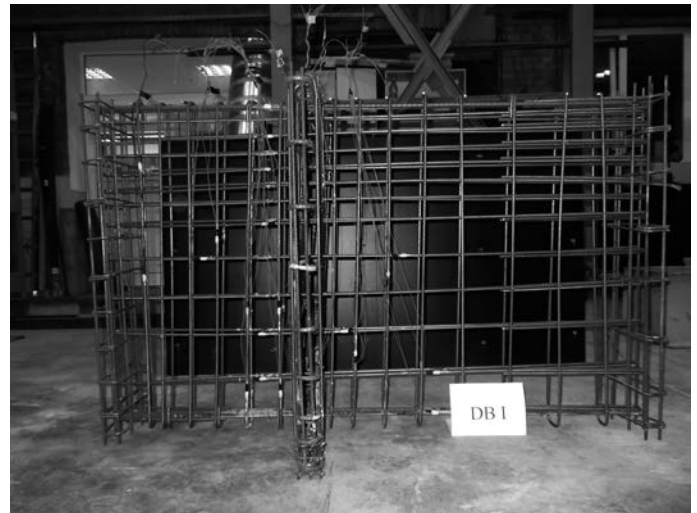
Rys. 3. Zbrojenie tarczy DB-I (zbrojonej ortogonalnie)
