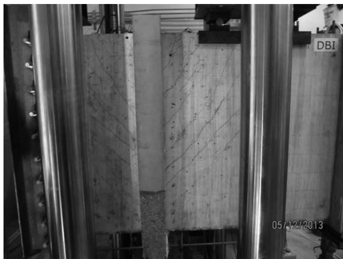
Rys. 10. Fotografia przedstawiająca zarysowanie wspornika tarczy DB-I przy zniszczeniu
