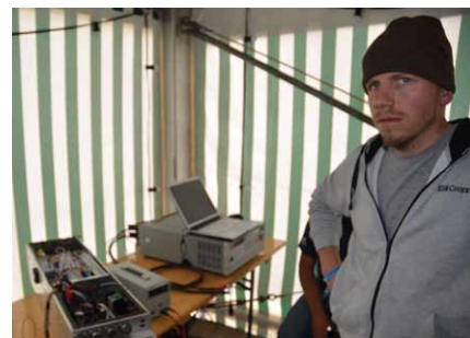
Doktorant, Wojciech Leśniewski, konstruktor układu zasilania i sterowania łodzi solarnej czeka na wynik pomiarów pojemności akumulatorów. Po lewej stronie, na stole, poddawane jest badaniom serce naszej łodzi wodoszczelna „trumienka” z elektroniką i akumulatorem
