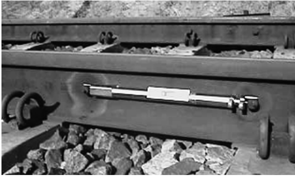
Rys. 2. Miernik sił podłużnych w szynach MS-02 [28]
