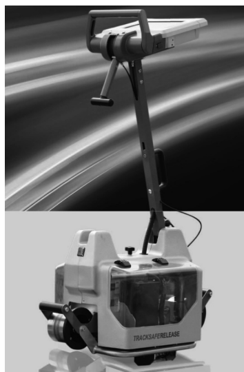
Rys. 6. Przyrząd pomiarowy Track Safe Release [27]
