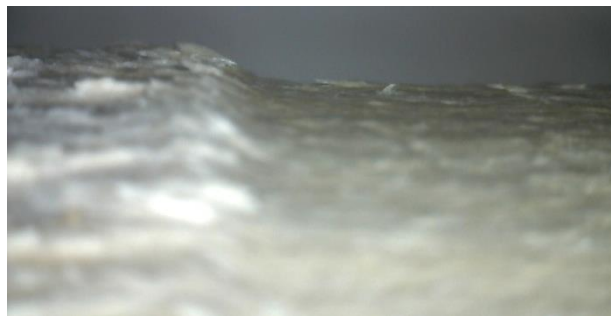
Rys. 6. Widok powierzchni drewna świerkowego po nagniataniu tocznym ( F_y = 225 \text{ N} , f = 0,5 \text{ mm} , n = 100 \text{ min}^{-1} ), gdzie: a) odwarstwienia włókien drewna, b) po lewej stronie powierzchnia po toczeniu, a po prawej powierzchnia po nagniataniu (widok tej samej próbki, powiększenie 40×)
