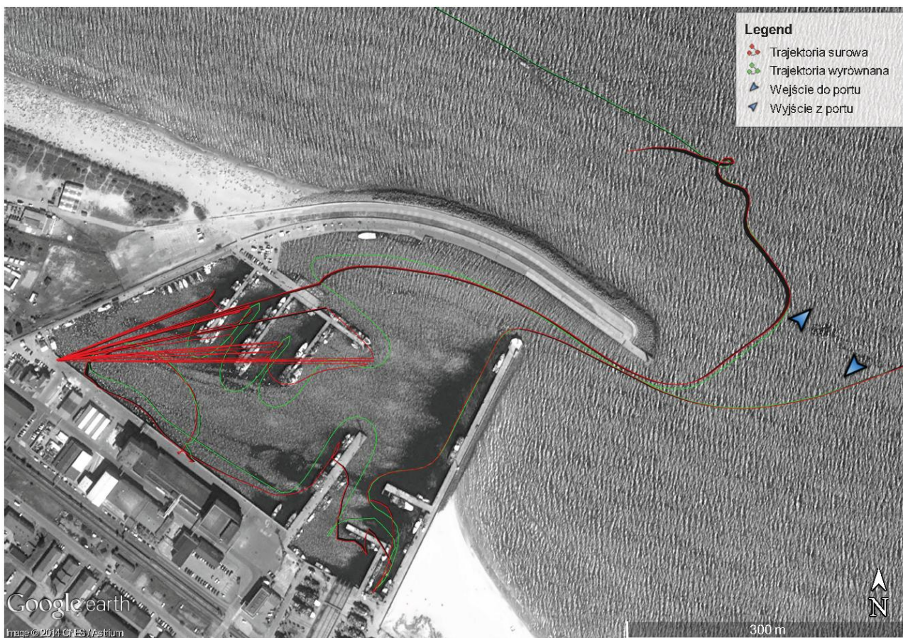
Rys. 9. Wizualizacja trajektorii ruchu jednostki skanującej zaimplementowanego do Google Earth™ w postaci pliku .kml
