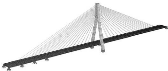
Rys. 5. Wizualizacja modelu obliczeniowego globalnego
