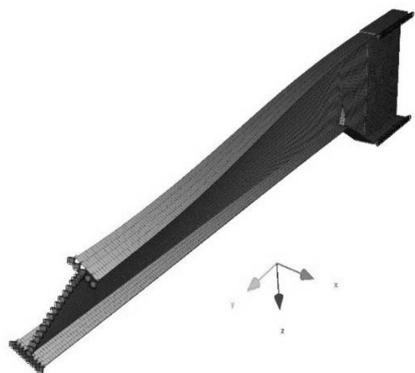
Rys. 9. Postać wyboczenia poprzecznic przy współczynniku 1,02
