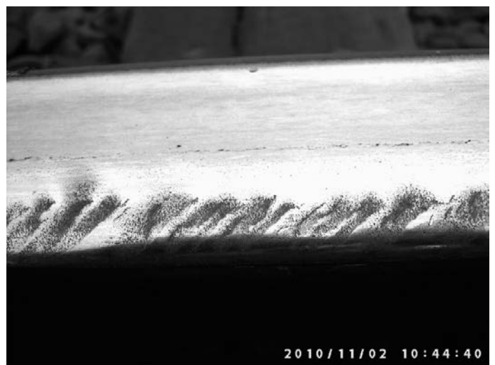
Rys. 14. Wady head check na powierzchni tocznej opornicy
