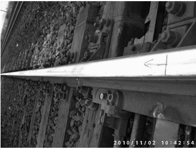
Rys. 12. Wady head check na powierzchni tocznej opornicy
