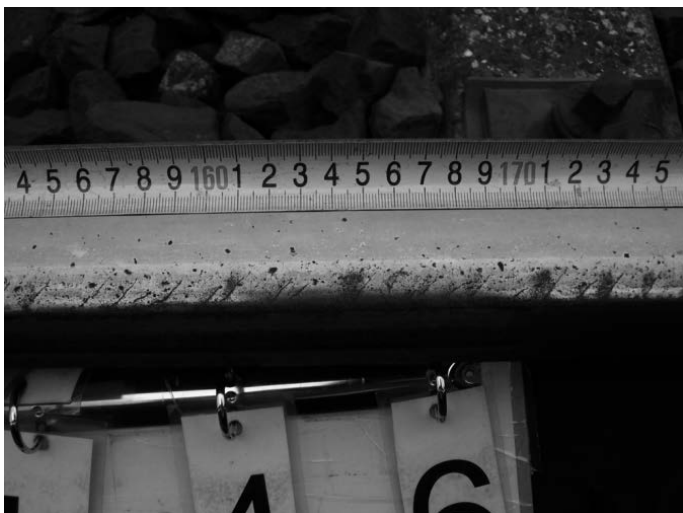
Rys. 4. Wada head check – rysy z zaciemnionymi zagłębieniami
