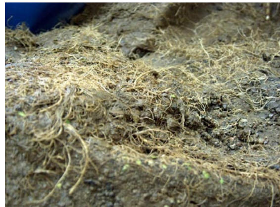
Rys. 8. Kolmatacja geowłókniny pyłem i korzeniami roślin
