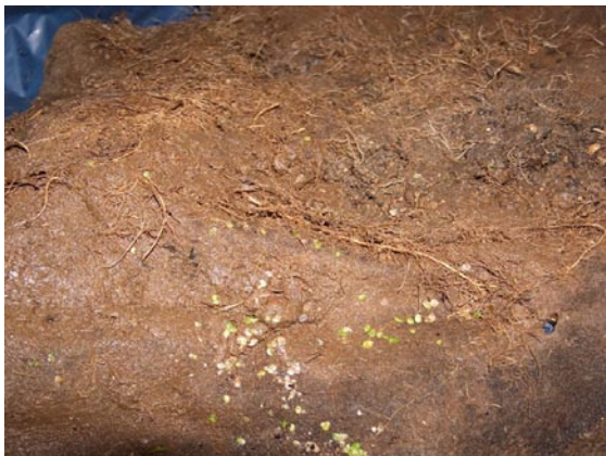
Rys. 8. Kolmatacja geowłókniny pyłem i korzeniami roślin
