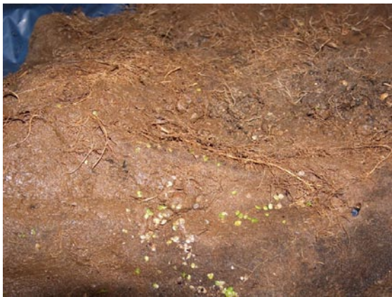
Rys. 8. Kolmatacja geowłókniny pyłem i korzeniami roślin
