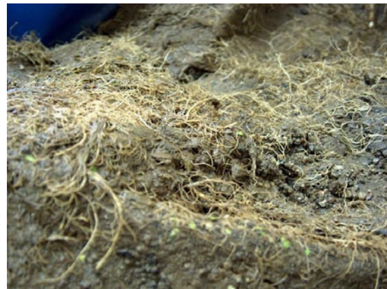
Rys. 8. Kolmatacja geowłókniny pyłem i korzeniami roślin
