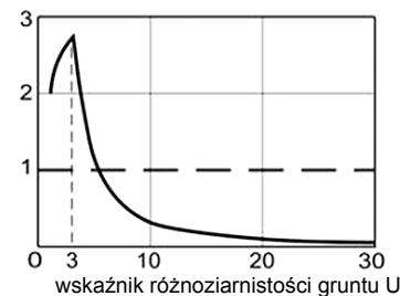
Rys. 3. Kryterium retencji według J.P. Giroud w zestawieniu z kryterium dostosowanym z filtrów odwrotnych [4]
