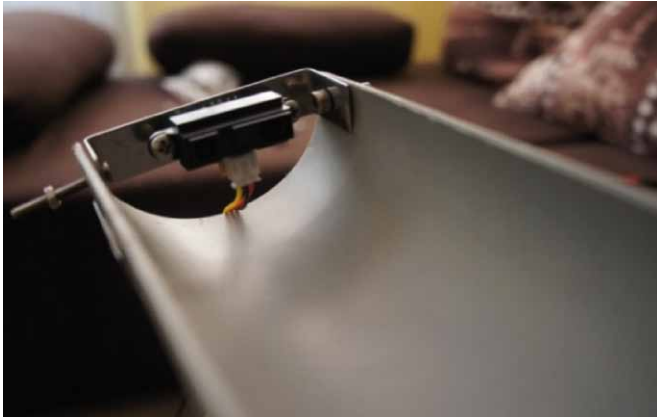
Rys. 5. Odbiciowe urządzenie pomiarowe zamontowane na równi pochyłej
