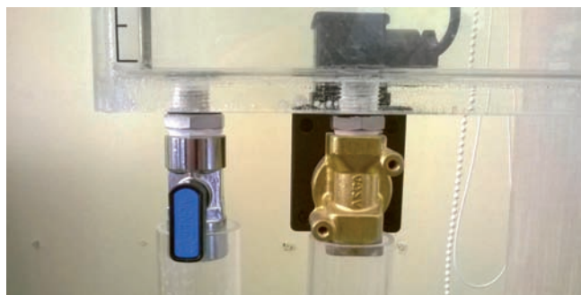
Rys. 4. Para zaworów – ręczny (lewy), sterowany (prawy) Fig. 4. Pair of valves – manual (left), controllable (right)
