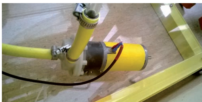
Rys. 3. Pompa DC Fig. 3. DC Pump
