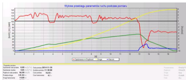
Rys.10. Niesprawny układ hamulcowy. Maksymalne opóźnienie hamowania 8,89 m/s 2 , wartość średniego rozwiniętego opóźnienia hamowania 4,65 m/s 2 , czas hamowania 4,1 s
