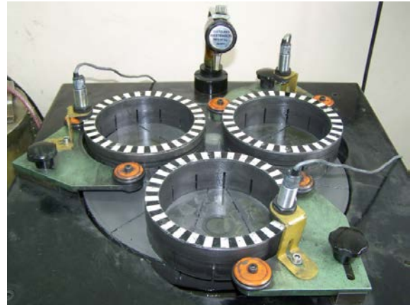
Rys. 6. Widok ogólny układu wykonawczego docierarki jednotarczowej stosowanej w badaniach
