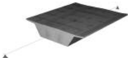
Rys. 8. Szczegółowy, belkowo-powłokowy model obliczeniowy MES w środowisku SOFiSTiK
