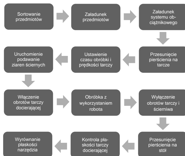
Rys. 5. Zasada działa systemu docierania z wykorzystaniem robota
