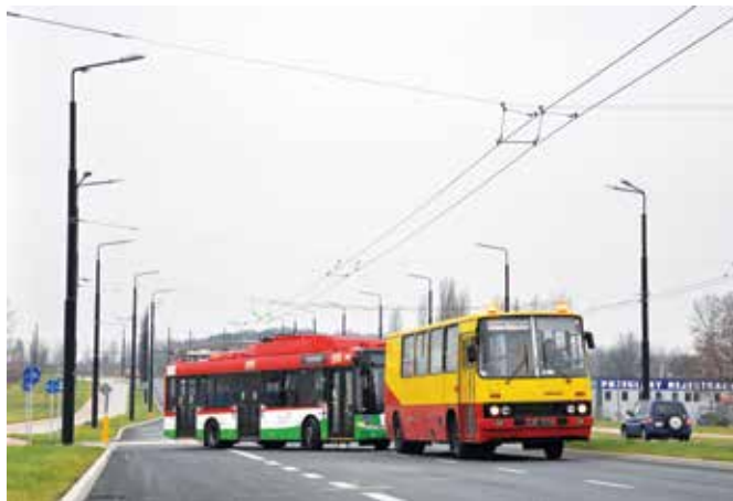
Fot. 15. Holownik zbudowany ze skróconego do jednej sekcji autobusu przegubowego Ikarus 280 w Lublinie. Fot. K. Grzonka
