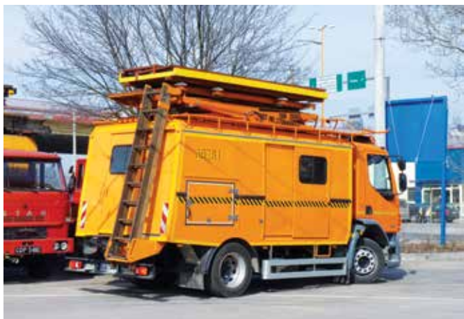
Fot. 19. Pogotowie DAF z widocznymi drzwiami (na poszyciu bocznym pod numerem taborowym), świadectwem modernizacji poprzez zabudowę agregatu spalinowego. Fot. M. Połom
