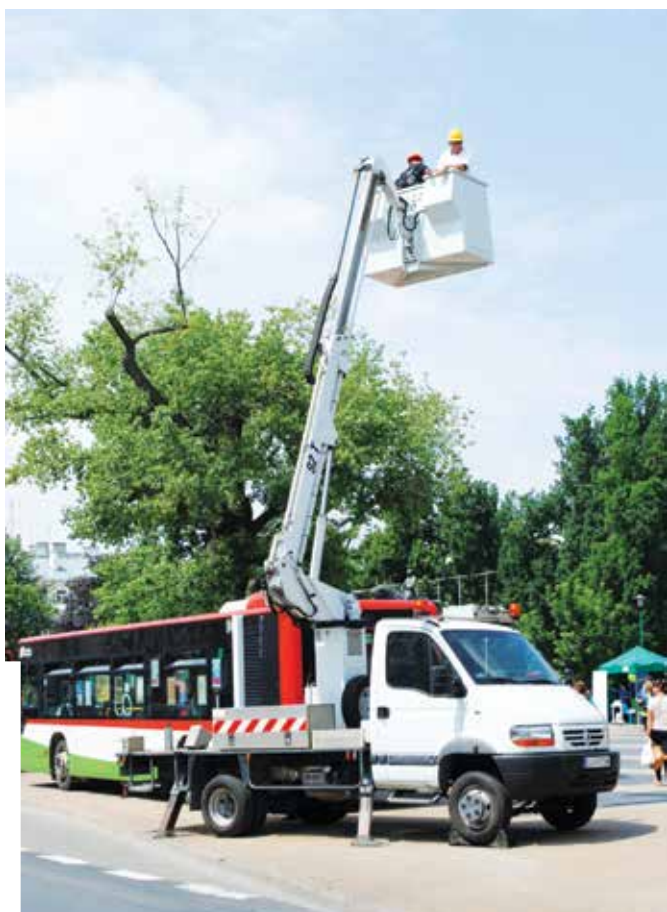
Fot. 21. Iveco należące do MPK w Lublinie wyposażone w podnośnik koszowy na ramieniu do prac sieciowych. Fot. M. Żyśko
