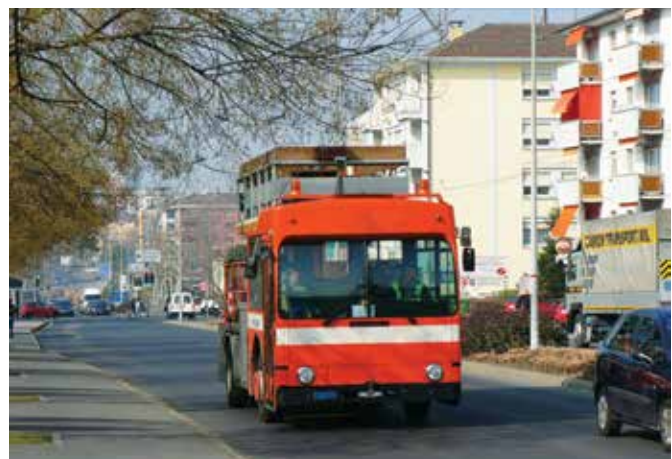
Fot. 8. Pogotowie sieci z nieskładanym pomostem w Lozannie (Szwajcaria). Fot. M. Bartłomiejczyk
