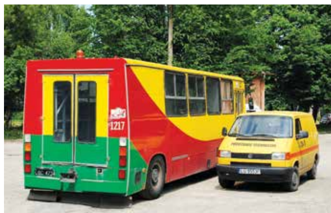
Fot. 17. Dwa rodzaje lubelskich pojazdów pogotowia technicznego: po lewej ciężkie pogotowie Ikarus 280/A o numerze 1217, służące dodatkowo jako holownik, i lekkie pogotowie VW Transporter T4. Fot. M. Zysko
