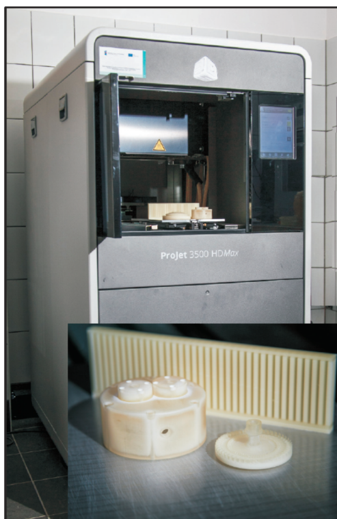
Rys. 1. Drukarka technologii MJP znajdująca się w laboratorium IMP PAN
