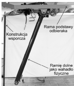
Rys.6. Widok stanowiska laboratoryjnego
