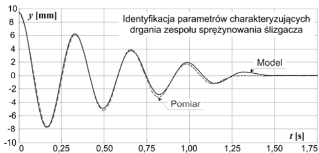
Rys.7. Przykładowy przebieg ruchu elementu odbieraka prądu
