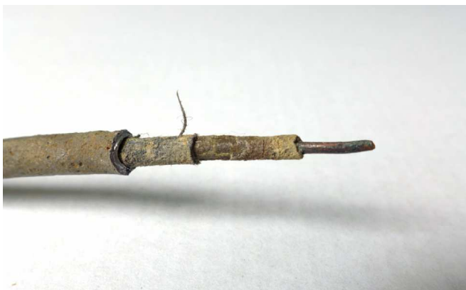
Rys. 13. Kabel z widocznymi warstwami izolacji
