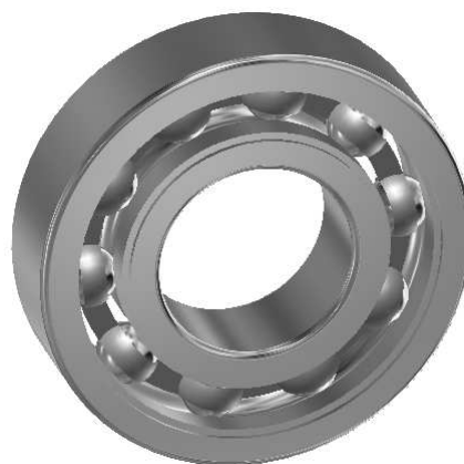
Rys. 16. Widok modelu 3D złożonego łożyska kulkowego
