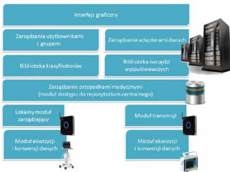
Rycina 2. Architektura warstwowa platformy IPMed
