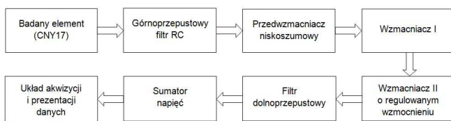
Rys. 2. Schemat blokowy zaprojektowanego toru pomiarowego
