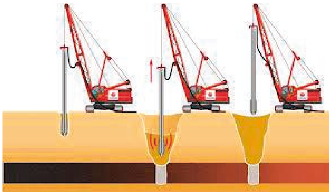
Rys. 2. Schemat wykonywania kolumn MMC
