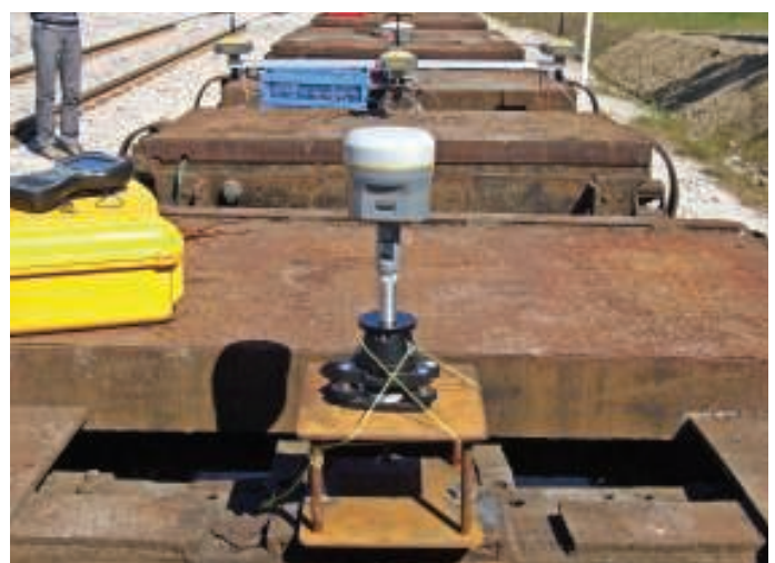
2. Odbiornik satelitarny Trimble R10 zainstalowany na wózku (kampania pomiarowa 2015)
