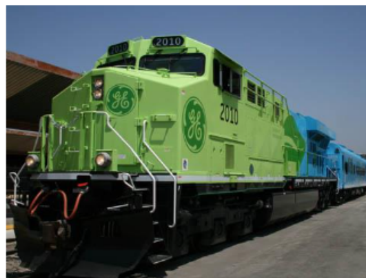
Rys. 1. Lokomotywa z hybrydowym układem napędowym [7]
