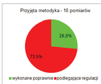
10. Procentowe przedstawienie ilości studni kanalizacyjnych wykonanych poprawnie i podlegających regulacji na wszystkich analizowanych odcinkach
