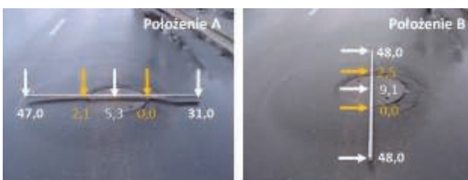
7. Przykładowe wyniki pomiaru deformacji studni zlokalizowanej na odcinku ulicy Podwale Przedmiejskie w Gdańsku
