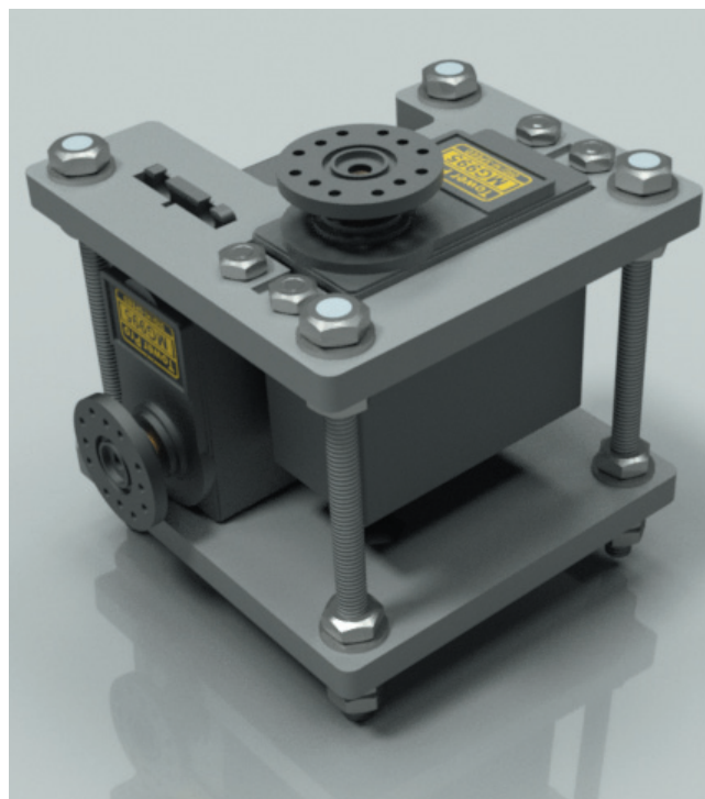
Rys. 1. Podstawka pod serwomechanizmy ze wszystkimi elementami łączącymi
