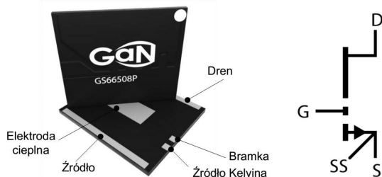
Rys. 2. Tranzystor GS66508P-E03 w obudowie GaNPX™ oraz jego symbol zastępczy
