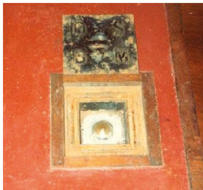
Rys. 6. Reper operacyjny zainstalowany w budynku Stacji Newlyn [31]
