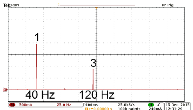
Rys.13. Przebieg napięcia przewodowego u_{ab} silnika oraz przebieg i harmoniczne prądu fazowego i_a silnika przy formowaniu pierwszej i trzeciej harmonicznej napięcia wyjściowego w układzie z filtrem sinusoidalnym (przebiegi na wejściu filtra sinusoidalnego). Skale: przebiegi: 2A/div, 400V/div, 10ms/div, harmoniczne 500mA/div, 12,5Hz/div,
