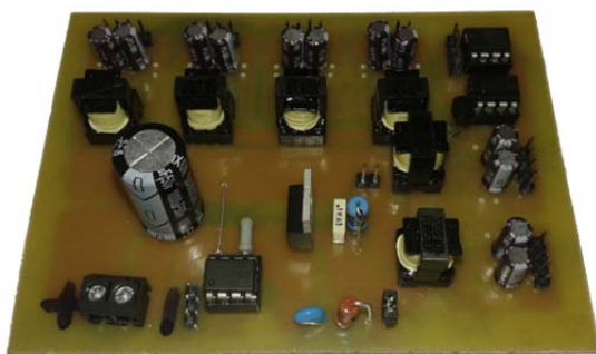
Rys. 2. Widok prototypu wielotransformatorowej przetwornicy typu Flyback
