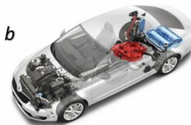
Rys. 1. Rozmieszczenie butli wysokociśnieniowych w autobusach (a) oraz pojazdach osobowych (b) [2]
