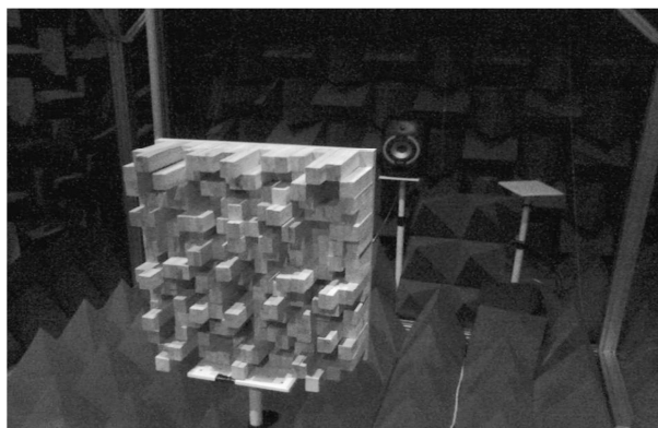
Rys. 2. Pomiar oddziaływania tylnej, płaskiej części dyfuzora (płyty). Pomiar na wysokości wynoszącej 123,4 cm od podłogi komory bezechowej do dolnej krawędzi dyfuzora. Na fotografii widoczne jest także źródło fali akustycznej (monitor odsłuchowy)
