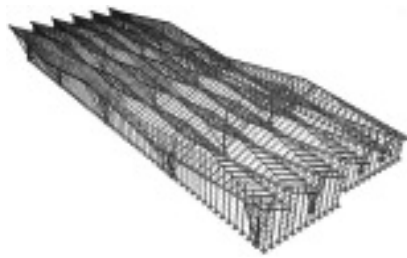
Rys. 2. Globalny model MES Terminalu (SOFiSTiK)
