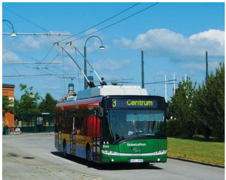
Fot. 2. Trolejbus przy zasilaniu sieciowym. Fot. M. Bartłomiejczyk
