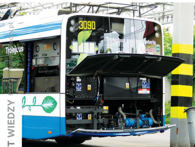
Fot. 3. Tylna część trolejbusu Solaris Trollino 12; widoczne są 3 moduły baterii (czarne skrzynki) oraz układ ładowania (szara skrzynka w górnej części aparatury)
