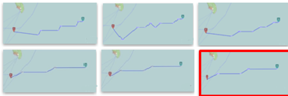
Rys. 5. Zobrazowanie efektywnej metody szukania suboptymalnej trasy: od lewej zaczynając w pierwszym rzędzie dla ziarnistości z = 73 \cdot 10^{-8} dla wariantów ruchu 8,16,32 w drugim rzędzie dla z = 293 \cdot 10^{-9} i wariantów ruchu 8,16,32
