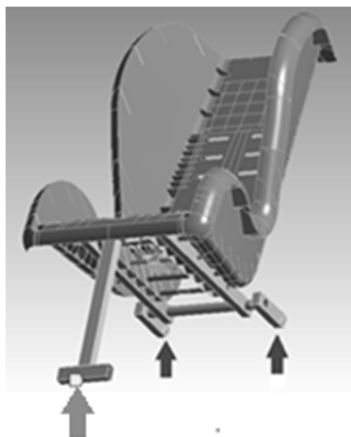
Rys. 5. Podparcie modelu: w uchwytach ISOFIX (dwie małe strzałki), powierzchnia podparcia modelu na dolnym końcu podpórki (strzałka w lewym dolnym rogu) [1]
