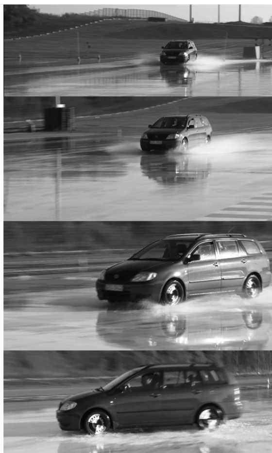
Fot. 5. Zablokowane koła samochodu – hamowanie bez ABS
