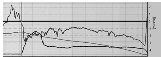
Rys. 4. Wykres parametrów ruchu podczas pomiaru. Niesprawnny układ hamulcowy oraz niedziałający układ ABS.
