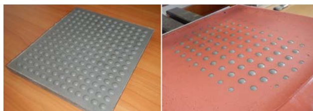
Rys. 1. Eksperymentalna nawierzchnia składająca się z regularnych sferycznych wybrzuszeń o wysokości XXX. mm. Z lewej strony widoczna pełna tekstura, a z prawej strony tylko ta jej część, która ma kontakt z gumą bieżnika (szary kolor)
